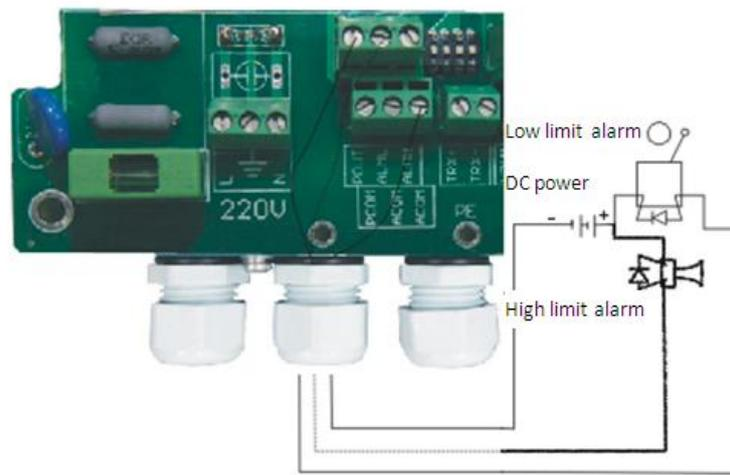
Fig. 1.4 (d) Alarm output wiring of square meter
